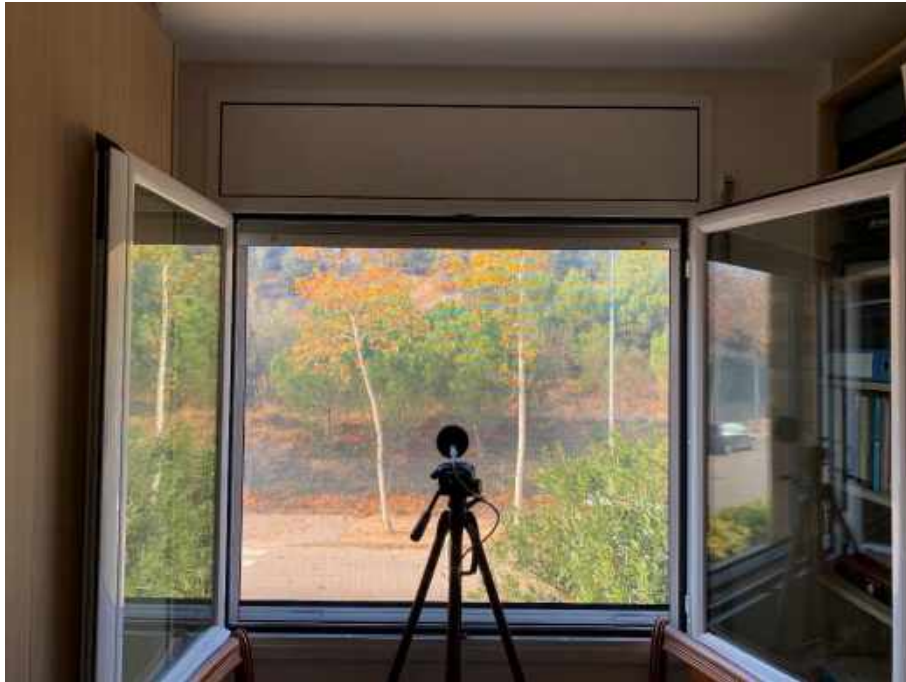
Imatge 5 – Punt de mesurament a la finestra del receptor sensible.
